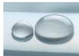
Капли воды с грязью и известковыми частицами на защищенной поверхности
